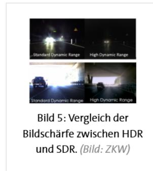
Die Beispiele in Bild 5 zeigen im direkten Vergleich den Unterschied zwischen zwei Kameras mit Standard- sowie hohem Dynamikbereich, wobei HDR eine sichtbar bessere Erkennung von Details bei schwierigen Lichtbedingungen ermöglicht, weil im überwiegenden Bereich des Bildes ein maschinell verarbeitbares Kontrastverhältnis von Bildelementen gegeben ist.
