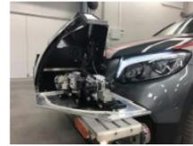
Bild 3: Der Kamera/Scheinwerfer-Prototyp im ZKW-Testfahrzeug sammelt Daten zur Bilderkennung. (Bild: ZKW)
