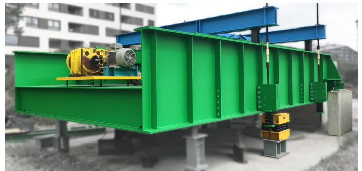
Bild 1 Großversuchsanlage zur Erforschung Gleisdynamik
