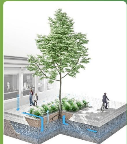
Abb. 3 Schematischer Aufbau Schwammstadt
