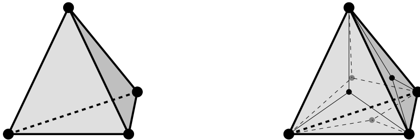
Abbildung 11: Wir haben eine Unterteilung der Seiten mit den gewünschten Eigenschaften. Verbinden wir nun noch jeden Knoten mit dem Schwerpunkt des Tetraeders, so erhalten wir die gewünschte Unterteilung. Für jedes entstandene Tetraeder wird der Schwerpunkt des ursprünglichen Tetraeders mit dem lokalen Index 2 nummeriert. Jedes der 12 entstandenen Tetraeder hat genau eine Kante gemeinsam mit dem ursprünglichen Tetraeder. Diese Kante ist die Verfeinerungskante.
