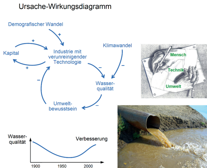
Abb. 6: Wechselspiel Mensch–Technik–Umwelt als komplexes System. Links oben: Ursache-Wirkungsdiagramm für die langfristige Änderungen der Wasserqualität. Links unten: Das durch das Ursache-Wirkungsdiagramm beschriebene komplexe System erklärt die Abnahme und Zunahme der Wasserqualität in der Westlichen Welt im 20. Jh. Sivapalan and Blöschl (2015). Rechts oben: Zeichnende Hände von M.C. Escher, 1948 als Metapher für komplexe Systeme.
