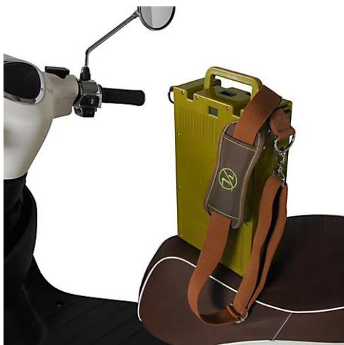
Abbildung 5 - Für den ständigen Transport konzipierter Akkumulator
