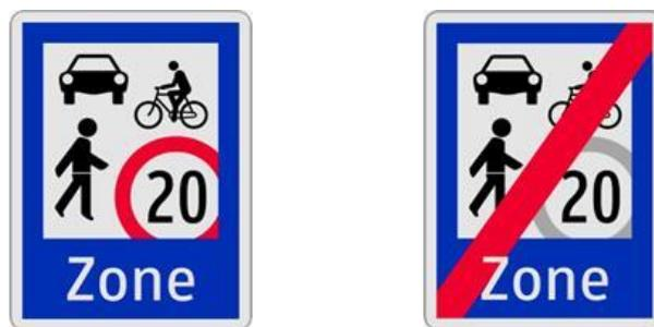
Abbildung 6.5: Beginn einer Begegnungszone mit 20 km/h Höchstgeschwindigkeit gem. § 53 Abs 1 Z 9e StVO 1960 (links); Ende einer Begegnungszone mit 20 km/h Höchstgeschwindigkeit gem. § 53 Abs 1 Z 9f StVO 1960 (rechts)
