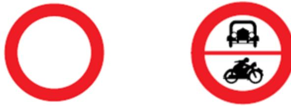
Abbildung 6.3 Fahrverbot (für alle Fahrzeuge) in beiden Richtungen gem. § 52 Abs 1 lit. a Z 1 StVO 1960 (links); Fahrverbot für alle Kraftfahrzeuge gem. § 52 Abs 1 lit. a Z 6c (rechts)
