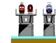
Abtrag der alten Pfeiler. Zustand im Endausbau mit drei neuen Gleisen.
