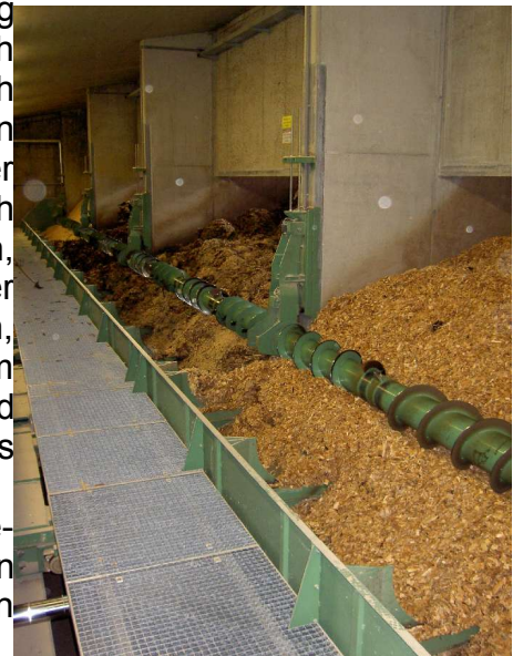
Illustration 9: Schubbodenanlage mit Querförderer zur Dosierung der Brennstoffzusammensetzung
