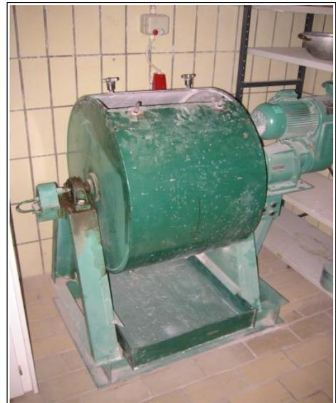
Abbildung 44: Los Angeles Prüfmaschine
