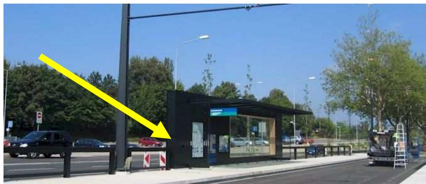
Ordnung zu bewahren, wie die Beleuchtung, eine Sprechanlage, Werbung und natürlich eine Fahrkartenerwerbsmöglichkeit. Außerdem ist in der Wand eine Notstrom Versorgung inkludiert.
