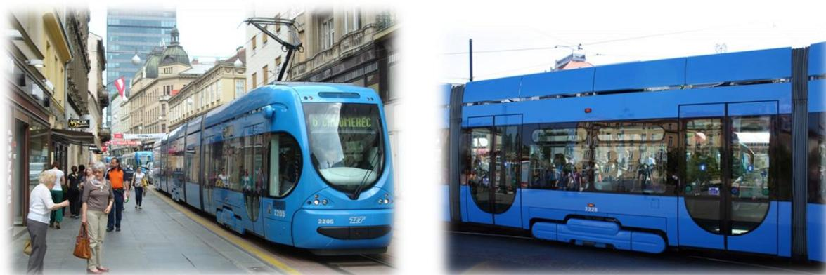
**Abb. 7: Straßenbahnfahrzeug der Baureihe NT 2200 mit 100% Niederfluranteil<sup>19</sup>**
