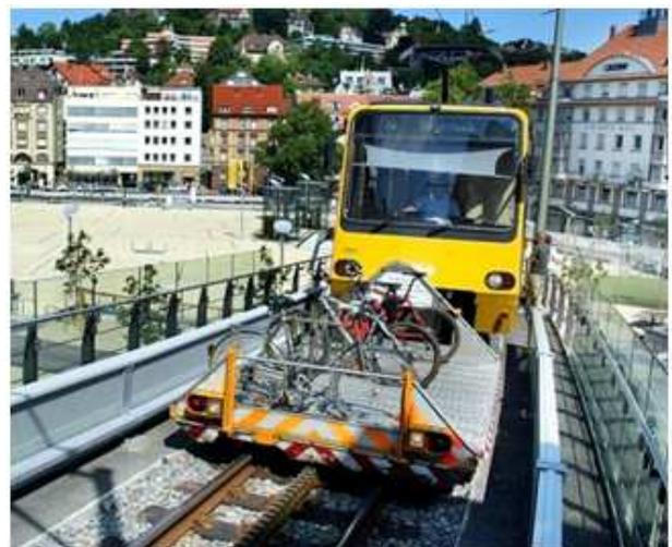
**Abb. 3** Bike Tram System am Beispiel der Stuttgarter Zahnradbahn (Quelle: <http://www.stuttgart.de>)
