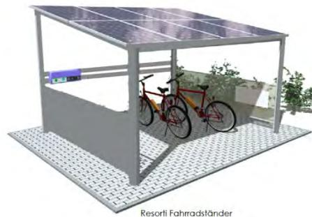
Unser Konzept beinhaltet überdachte Fahrradabstellplätze, welche mit einer Photovoltaikanlage betrieben wird. Diese Anlage bietet ausreichend Strom für eine E-Bike-Ladestation und Licht im Dunkeln. Durch die Überdachung sind die Fahrräder witterungsgeschützt und laden auch dazu ein, bei leichtem Regen das Fahrrad zu nutzen, denn der Sattel bleibt somit trocken.
