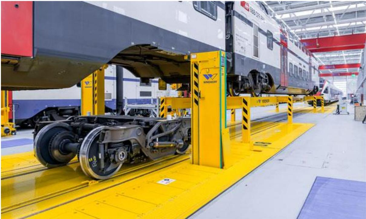
**Abb. 7:** Unterflurhebeanlage der Firma WINDHOFF [WINDHOFF, 2019]
