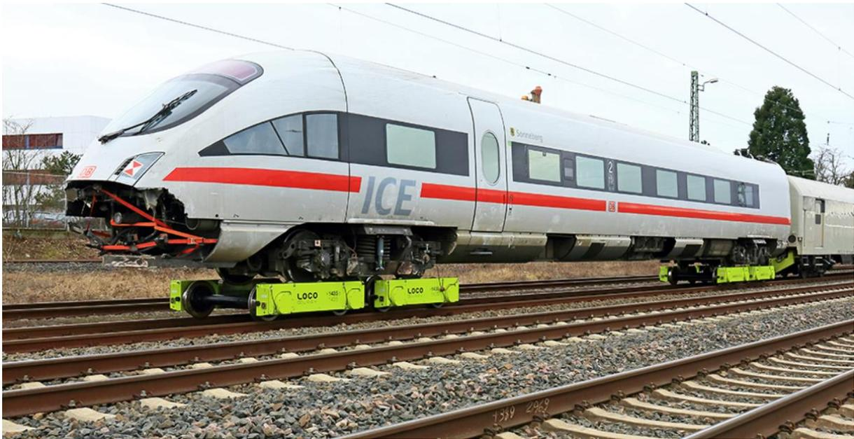
**Abb. 14:** Loco Buggy beim Transport eines verunfallten Triebwagens [RailAdventure GmbH, o.D.]
