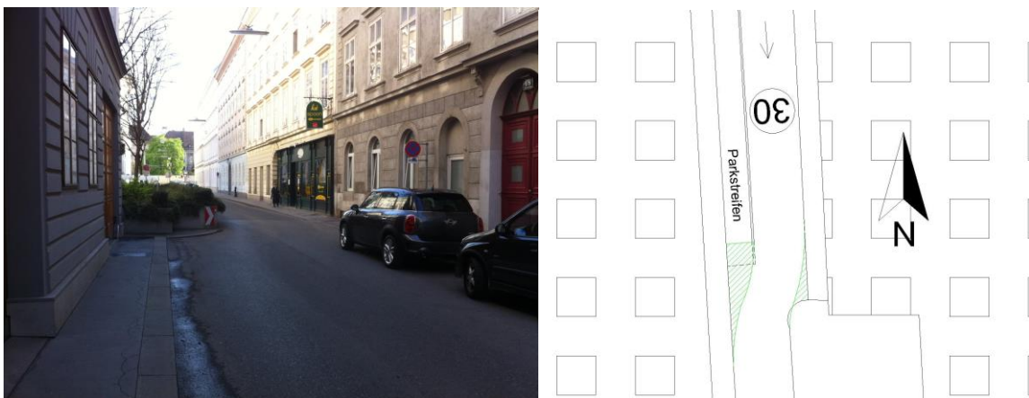
Abb. 9 + 10: Bild links: Ist-Zustand der Fahrbahnversetzung in der Salesianergasse, Bild rechts: Verbesserungsvorschlag der Ausführung
