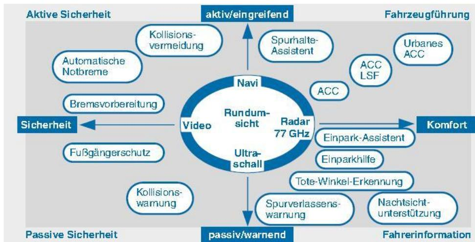
Abb. 8: Sicherheits- und Komfortfunktionen basierend auf Rundumerfassung von Sensoren [10]
