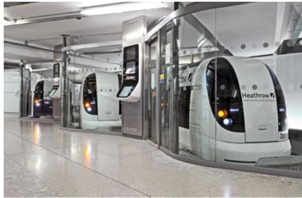
**Abb.10:** selbstfahrende Kabinenfahrzeuge mit Elektroantrieb [23]
