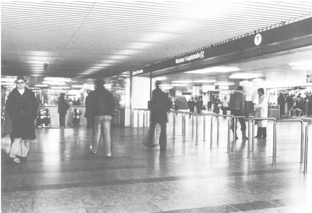
Abbildung 4: Durchgehende Sperrenreihe zwischen den Abgängen zu U1/U2 und U4 [3, S. 201]
