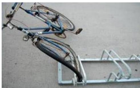
Abbildung 5.4: beschädigtes Rad durch Vorderradhalter (Hemetsberger, 2013, S. 7)
