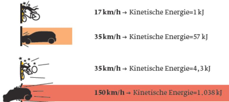
Abbildung 6: Darstellung der kinetischen Energie
