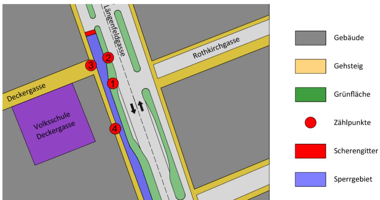
**Abb. 18:** Definition der Zählpunkte und Position des Scherengitters, eig. Darstellung
