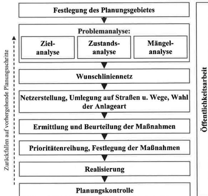
**Abb. 6:** Planungsablauf für die Erstellung eines Radverkehrsnetzes [4]
