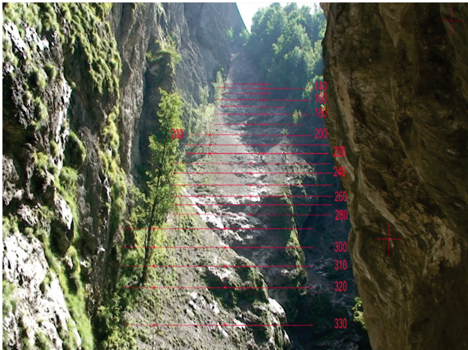
Abbildung 14: Zu analysierende Sturzbahn in der Liechtensteinklamm. Die roten Linien dienen in der Videoanalyse zur Ermittlung der Sprungweiten (Photo: Roland Rauscher).
