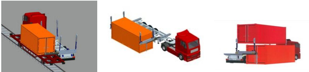
(a) Verladung mittels MCU auf die Schiene      (b) Abladen mittels MCU auf den Boden      (c) Abladen mittels MCU auf einen Container
