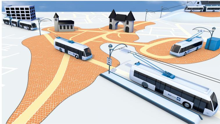
**Abb. 13:** Stadtplätze können frei von Oberleitungen bleiben. Im Zentrum wird der Akku als Stromquelle genutzt. Beim Verlassen des Stadtzentrums werden die Stromabnehmer automatisch an die Oberleitung angeschlossen. Rechts im Bild ist ein Bus zu sehen, der über *Opportunity Charging* die Akkus zusätzlich auflädt.
