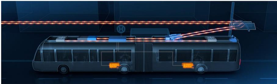
**Abb. 11:** Zuletzt wird der Stromabnehmer wieder an die Oberleitung angeschlossen, um die Akkus während der Fahrt laden zu können.
