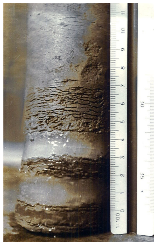
Eislinsenwachstum an Prüfkörpern unmittelbar nach dem Frosthebungsversuch, gefördert durch laufenden Grundwassernachschub; ice lenses in specimen immediately after a frost heave test, enabled by groundwater supply.
