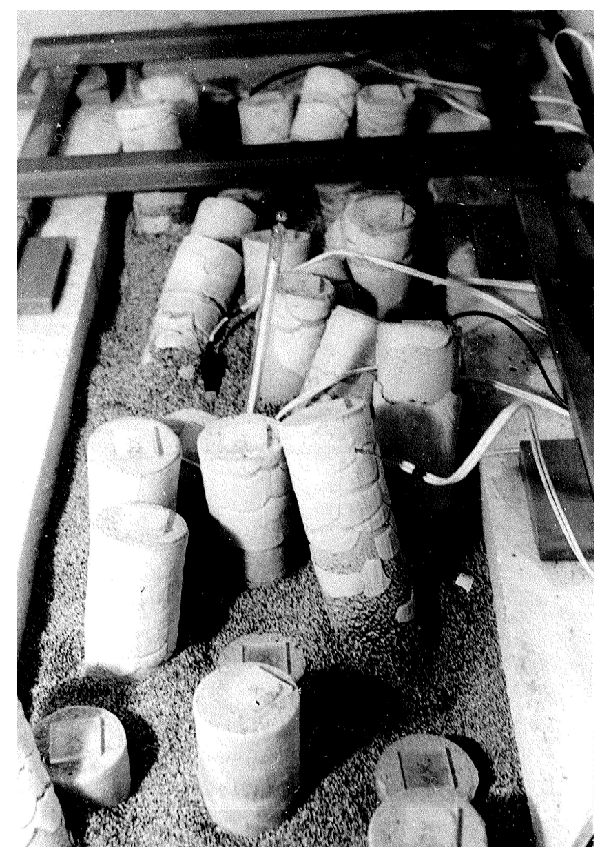
Prüfkörper in der Versuchseinrichtung bei Versuchsende; specimen in the frost basin after a frost heave test.
