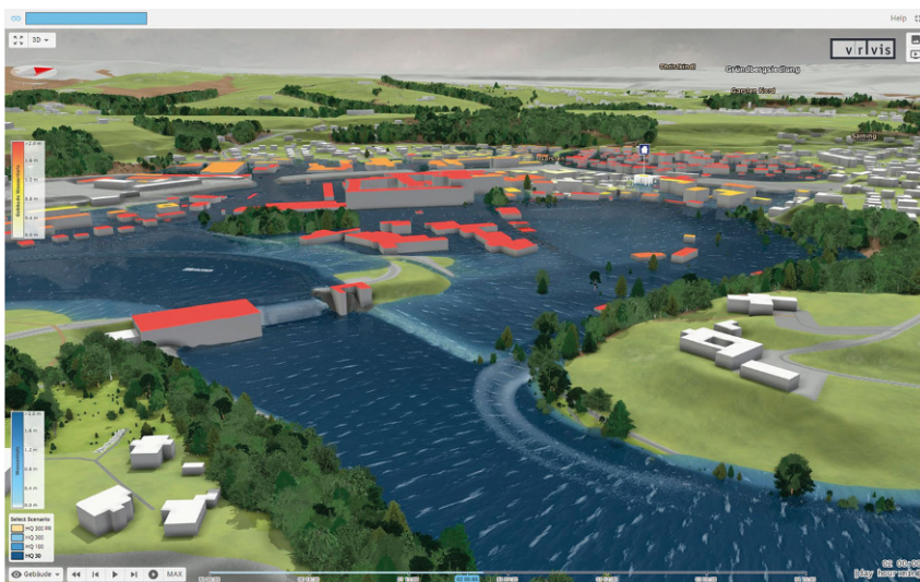
Abb. 5 3D-Visualisierung des simulierten Wassers mit Einfärbung, Wellen und Schaum. Die Gebäudedächer werden entsprechend der maximalen Wassertiefen eingefärbt
