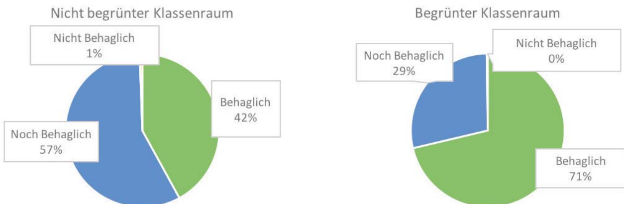
Abb. 52: Häufigkeiten der unterschiedlichen Behaglichkeitsstufen im nicht begrünten Klassenraum (links) und im begrünten Klassenraum (rechts), zwischen 1. Oktober und 31. März in den Jahren 2016, 2017 und 2018.
