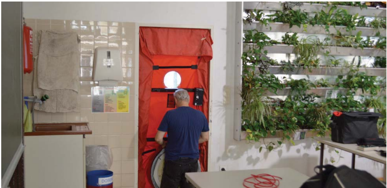
Abb. 48: Techniker der TU-Wien beim Vorbereiten des Raumes mit dem Blower Door Test für die Ermittlung des CO 2 -Gehaltes in der Raumluft.
