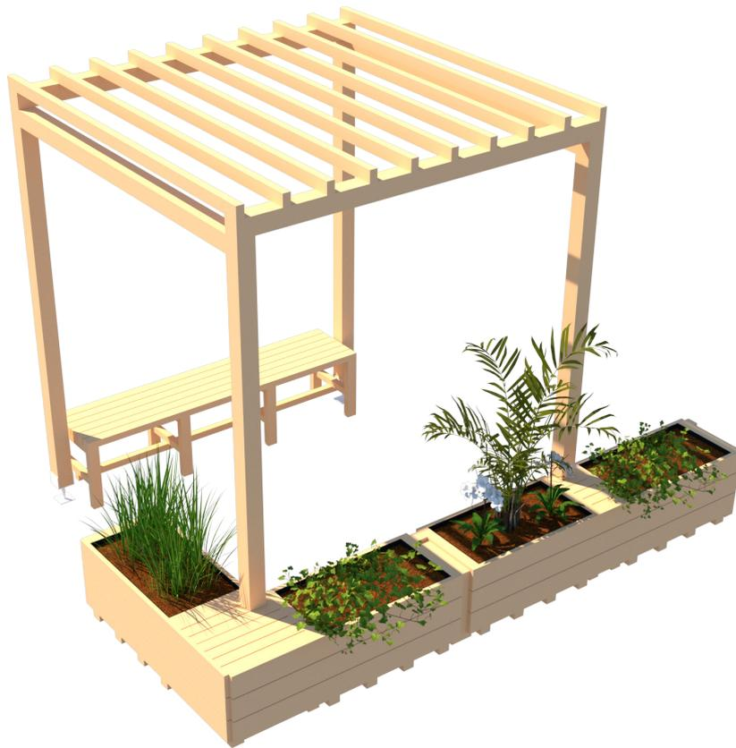
Das modulare Design des **Green Classrooms** ermöglicht kleine bis große Klassenräume an der frischen Luft. Der Steher-Raster erweitert sich immer um das selbe Maß, wobei die mittleren Stützen auf eine Stütze reduziert werden. Es ist individuell zu entscheiden, wieviele Pflanzentröge und Sitzgelegenheiten umgesetzt und nach eigenem Belieben angeordnet werden.
