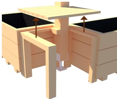
Zunächst die Löcher für die oberen Holzdielen auf den Latten anzeichnen und mit dem Holzbohrer  $\varnothing$  2,5mm vorbohren. Dann die Holzdielen von unten nach oben anschrauben.
