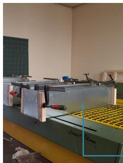
Zusätzlich sind die Kanten mit dem Montagekleber zu verkleben/abdichten.
