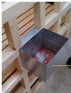
Sind alle Bleche gebogen, werden die Seitenbleche in das Hauptblech eingesetzt und von außen nach innen verschraubt.
