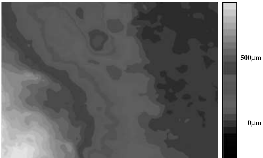
Abbildung 6.14: REM-Aufnahme am Rand der Probe A8 (Duplexstahl, Orientierung A). Das untere Bild zeigt eine Fehlpassungskarte, die durch Überlagerung der DEMs des oberen Bildes sowie seines Gegenstückes erzeugt wurde. Jede Farbabstufung entspricht einer Fehlpassung von 50 µm.
