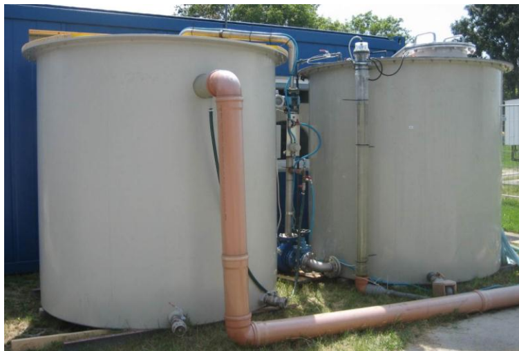
Abbildung 7 Reaktoreinheit; rechts O 3 -Eintragsbehälter, links Reaktionsbehälter mit oben liegendem Ablaufrohr
