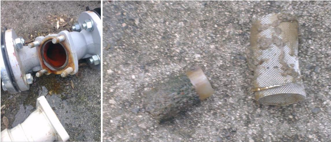
Abbildung 22: Foto links: Einbau GAK-Schmutzfänger, Foto rechts: Sieb von Wasserzähler (links) und belegter GAK-Schmutzfänger (rechts)
