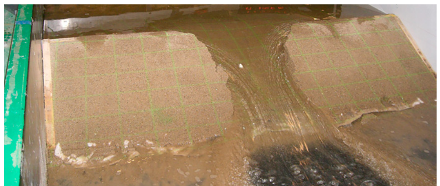
Hydraulischer Modellversuch zum Bruchverhalten eines Dammes bei Überströmung
