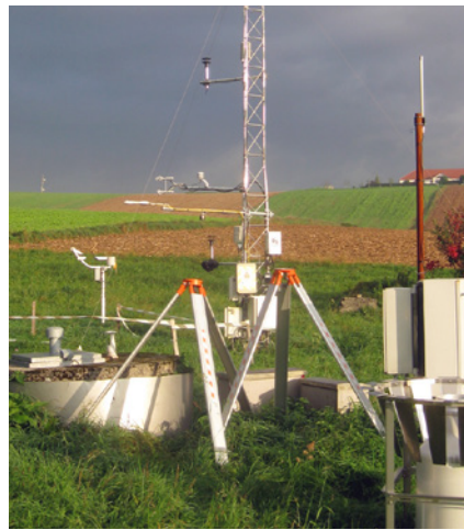
Messung der Verdunstung mittels Eddy-correlation im HOAL
