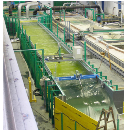
Physikalischer Modellversuch: Untersuchung von Strömungen nach Einbringung gröberer Sohlmaterials
