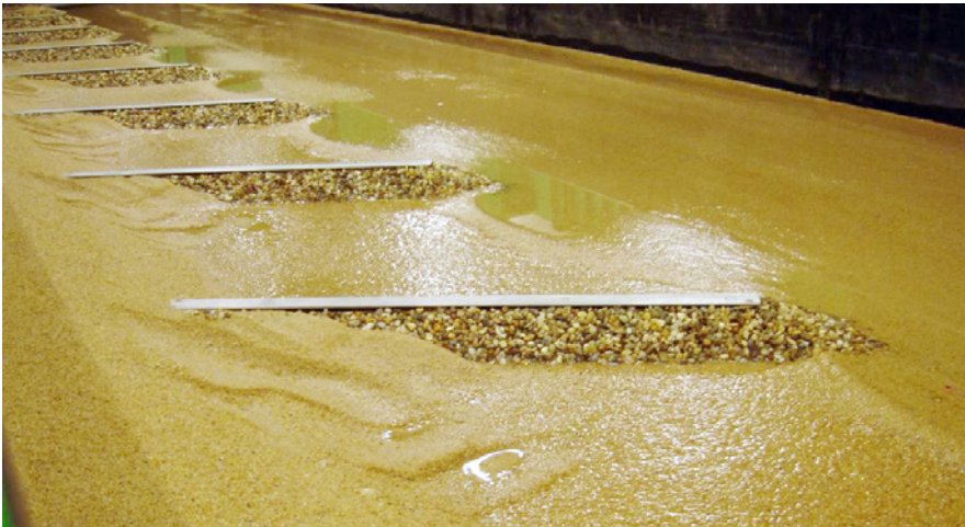
Physikalischer Modellversuch: Untersuchungen zur Optimierung von Buhngeometrie und -abständen
