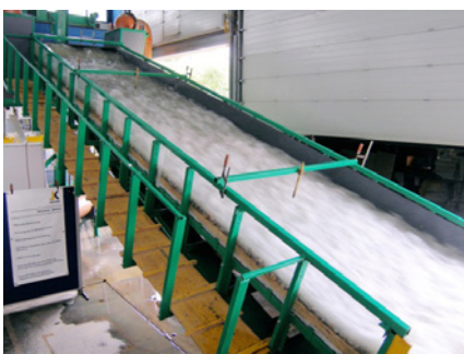
Modellversuche zur Sicherung von Überströmstrecken von Dämmen mit unterschiedlichen Materialien und Methoden
