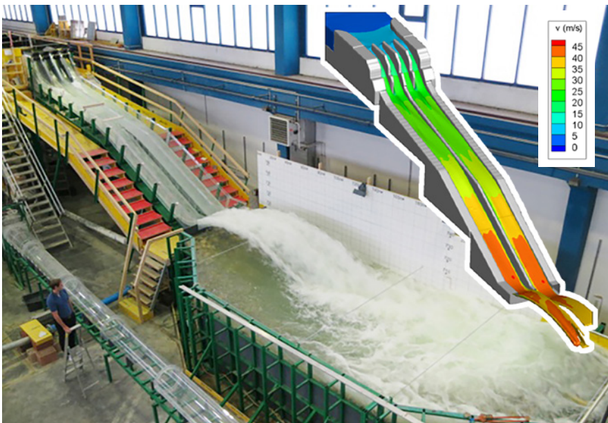
Physikalisches Modell (M=1:35) sowie numerische Simulation einer Schusssrinne mit Kolksee zur Energieumwandlung, Entwurfsdurchfluss 3500 m 3 /s in der Natur
