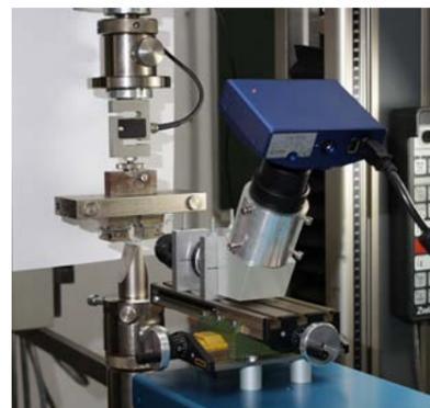
Biegeprüfanordnung mit Mikroskop zur Rissbeobachtung in PE-UHMW.
