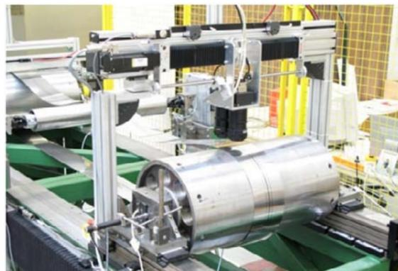
Prüfstand für das Laufverhalten von Prozessbändern
