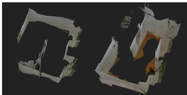
Bild 10. Tracking ohne Features, das Modell weist Faltungen auf Abb.: Irschik
