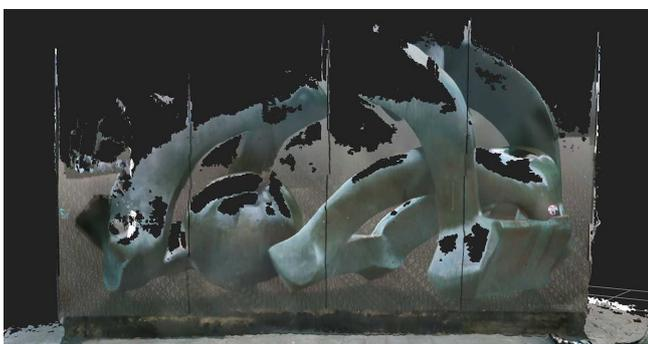
**Bild 3.** Scan 2 der Einhausung einer Brunnenskulptur mit schlechten Ergebnissen bei stärkerer Beleuchtungsstärke *Abb.: Irschik*
