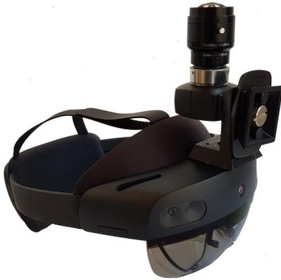
**Bild 12.** Laserprojektor mit aus kurzer Entfernung auf die Wand projiziertem Punktmuster (links), AR-HMD mit zusätzlicher Kamera für die Erfassung der Punkte (rechts) *Abb.: Schönauer*
