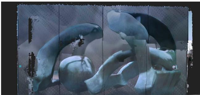
**Bild 2.** Scan 1 der Einhausung einer Brunnenskulptur mit guten Ergebnissen bei geringer Beleuchtungsstärke *Abb.: Irschik*
