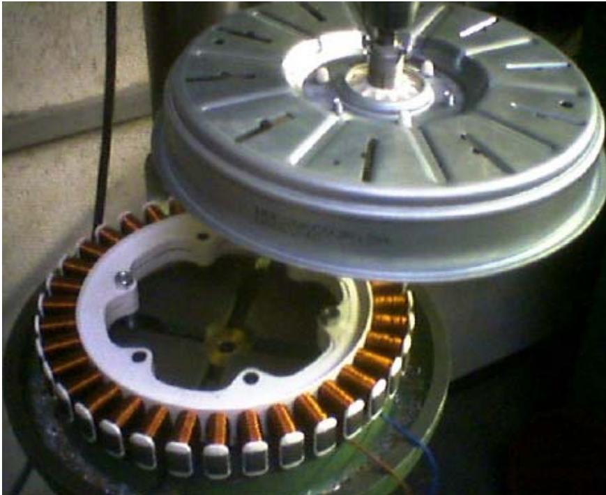
**Beispiel:** PM-Waschmaschinenantrieb mit Außenläufer, Zahnpulen, Luftkühlung
