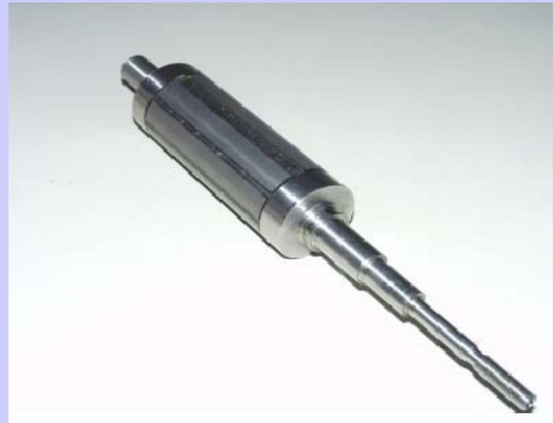
Entwickelter Rotor ohne Armierung
