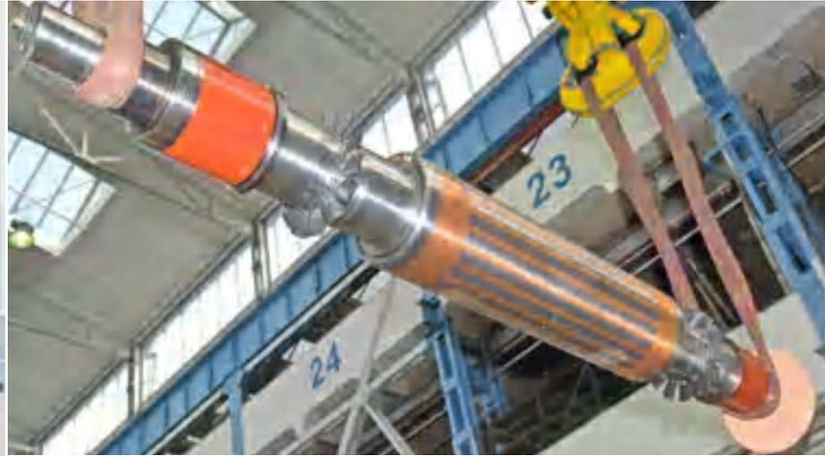
15000/min, 4 MW Käfigläufer-Asynchronmotor
