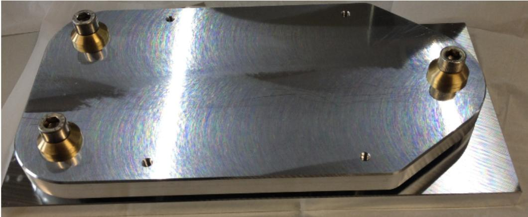
Abbildung 3.6: Neue Grobverstellung für die Nanopositioniertische.
