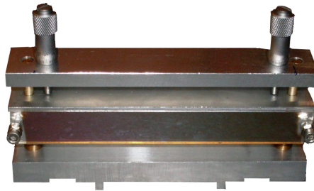
Abb. 2.5: Der Spurdetektor wird mit zwei Schrauben am Halter befestigt und mit Hilfe der beiden Mikrometerschrauben in Höhe und Neigung justiert.
