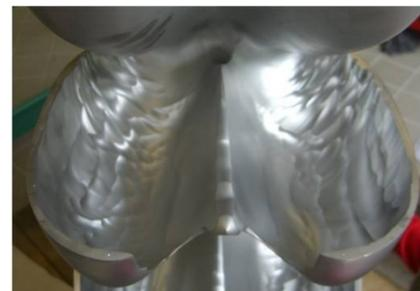
Abb.2.2: Durch Sediment Erosion beschädigter Peltonbecher
