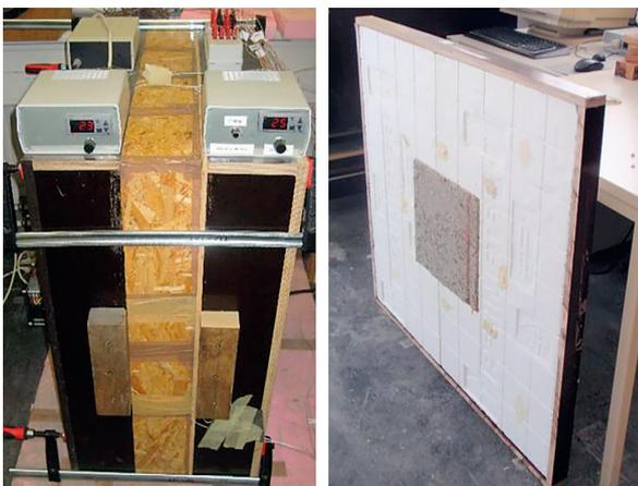
Abb. 4: Versuchsaufbau zur Messung der Wärmedämmeigenschaften (Wärmeleitfähigkeit)
