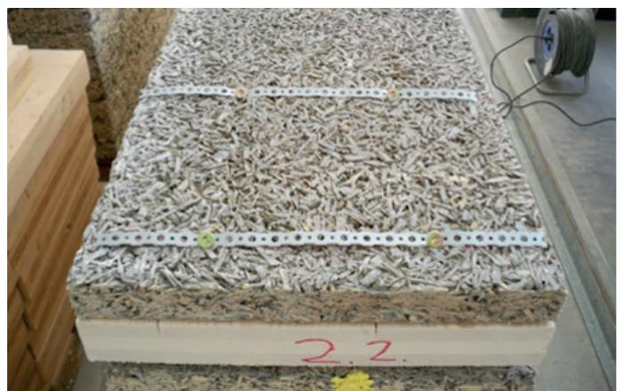
förderten Forschungsprojektes „Tragende Massivholzelemente mit mineralisch gebundenen Holzleichtbetonlagen | WooCon (Wood-based concrete: building construction with composite elements of wood-concrete compounds and timber)“ werden tragende Bauteile, die aus Holz und Holzleichtbeton bestehen, entwickelt (Abb. 19).
