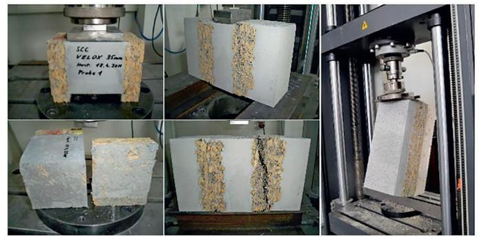
Abb. 2: Schubversuche an HLB-Verbundkonstruktionen
