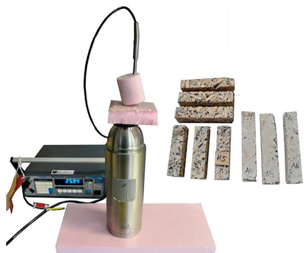
Abb. 5: Versuchsaufbau zur Messung der Wärmespeicherkapazität
