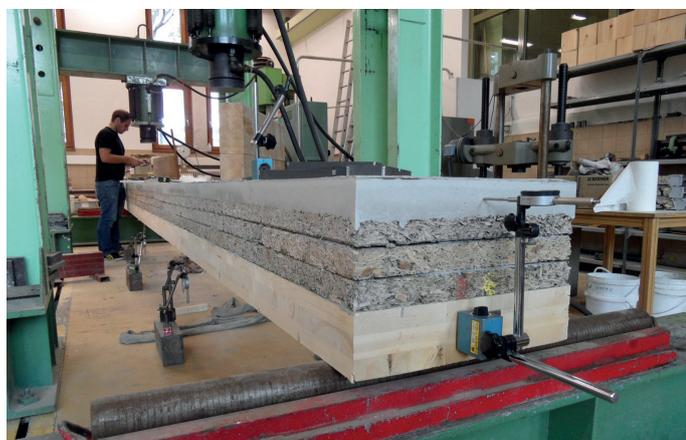
Abb. 19: Schichtaufbauten der durchgeführten 4-Punkt-Biegeversuche
