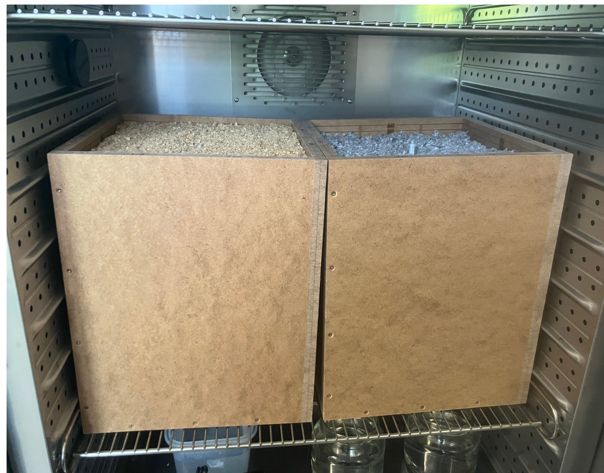
Abb. 4: Setzungsversuche bei Klimabeanspruchung zur Charakterisierung von granuliertem Mycomaterial als Einblasdämmstoff.
