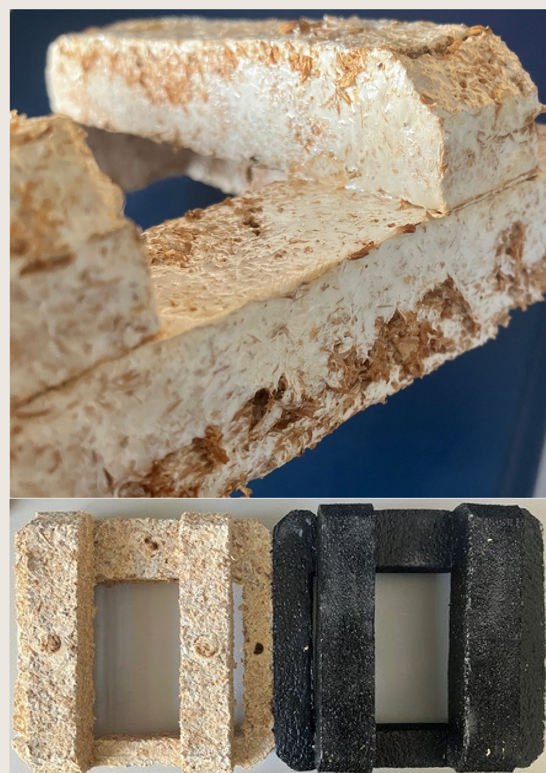
Abb. 1: Myco-Material nach Vorbild einer realen Polystyrol-basierten Formverpackung.
