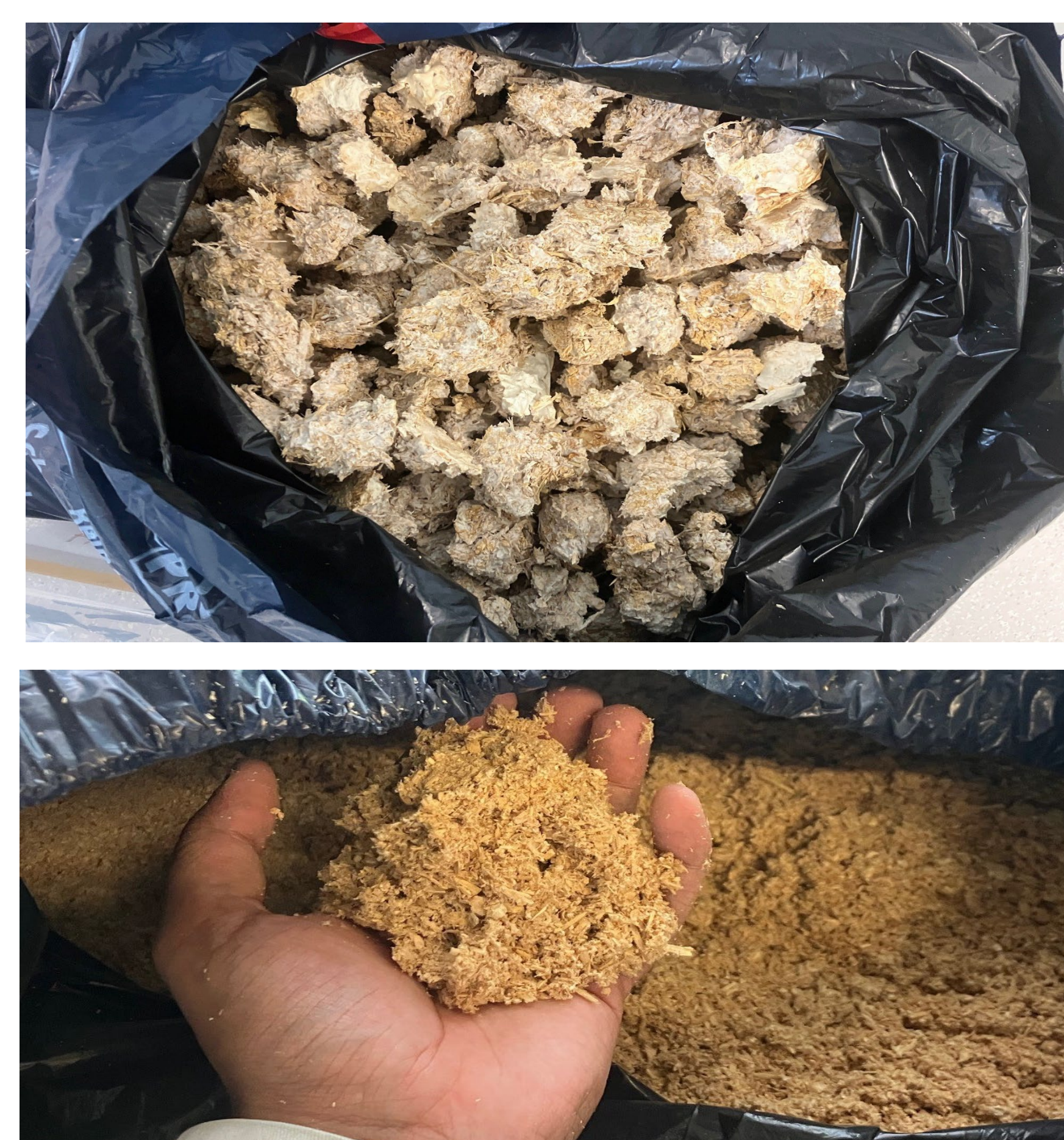
Abb. 3: Durch die Zerkleinerung des Materials wird ein leichter Faserstoff erhalten, welcher besonders gute Isolationseigenschaften aufweist.
