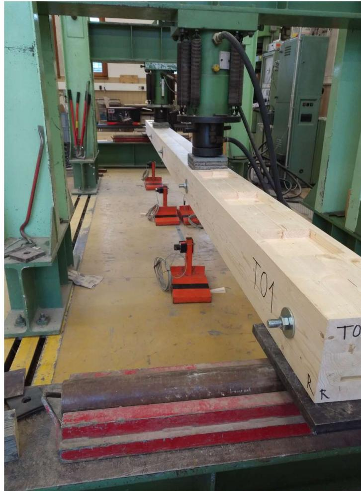
Abb. 8.3: Versuchsanordnung zur Bestimmung des E-Moduls
