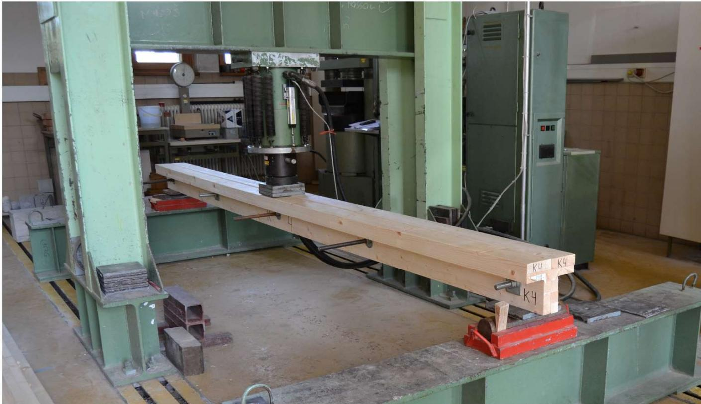
Abb. 7.17: Versuchsanordnung zur Bestimmung des E-Moduls
