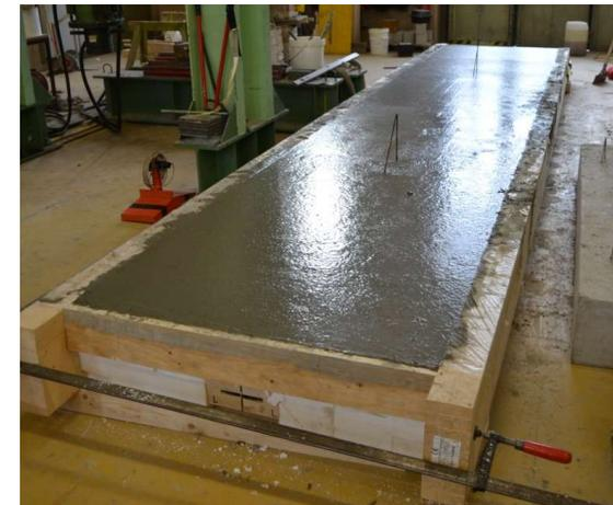
Abb. 8.6: Montage des 6m-Trägers
