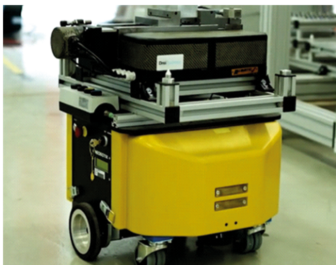
Autonomes Handling des 5G-Maschinenschraubstockes (damals noch als Prototyp) in der Fertigungshalle
