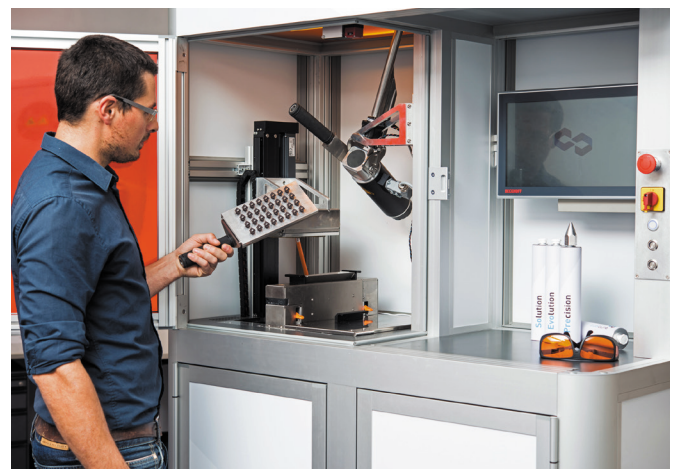
Hot Lithography Produktionsanlage für hochviskose Photopolymere
