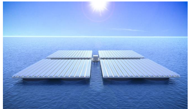
Solkraftwerk und Wasser-Entsalzungsanlage (4 x 300 x 300 m)
