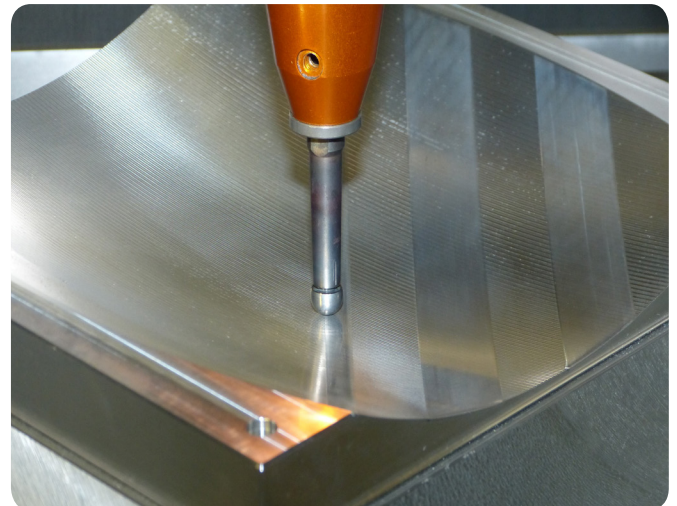
Funktionalisierte Oberfläche durch automatisiertes Hämmern
